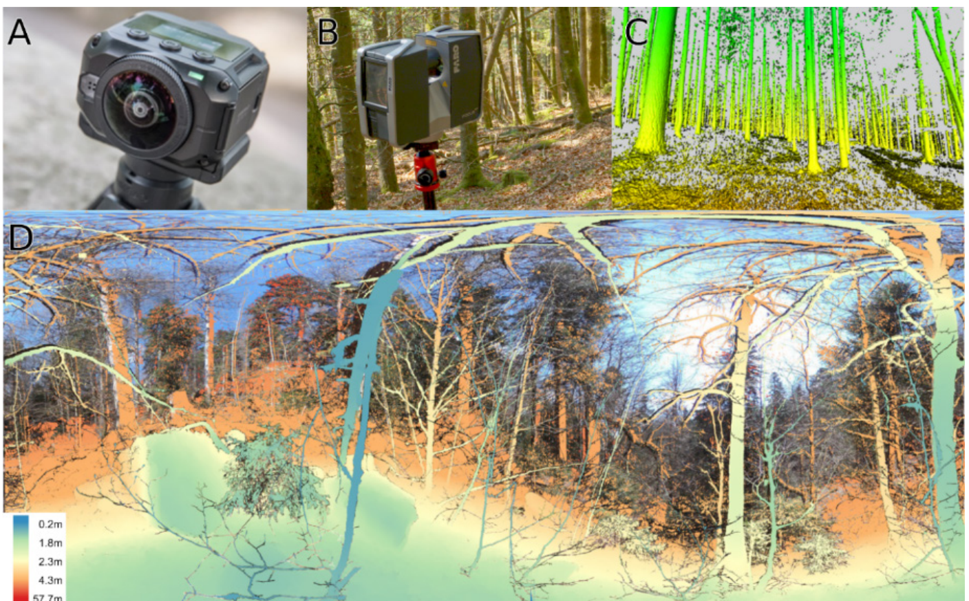
Abbildung 1: A) Spezialkamera zum Aufnehmen von 360°-Panoramabildern; B) Laserscanner; C) 3D-Modell aus den Laserscandaten; D) Überlagerung der Distanzinformationen aus dem Laserscanner auf der Panoramaaufnahme der Kamera.
